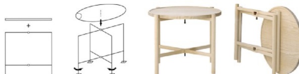
Obr. 19 Stůl s odnímatelnou stolovou deskou a se skládacím podstavcem (Joščák, 2014)
