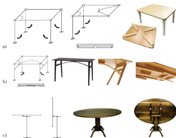
Obr. 20 Stoly se sklápěcími konstrukčními částmi stolu – sklopná stolová deska (Joščák, 2014)
