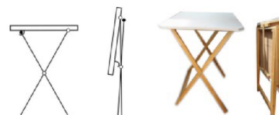
Obr. 21 Stoly se sklápěcími konstrukčními částmi stolu – sklopný podstavec (Joščák, 2014)
