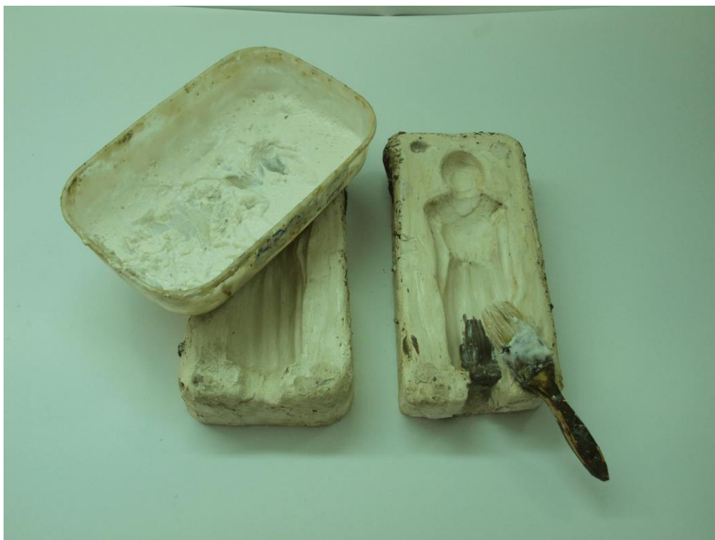
Obr. 36 Vymazání formy mýdlovou hmotou
