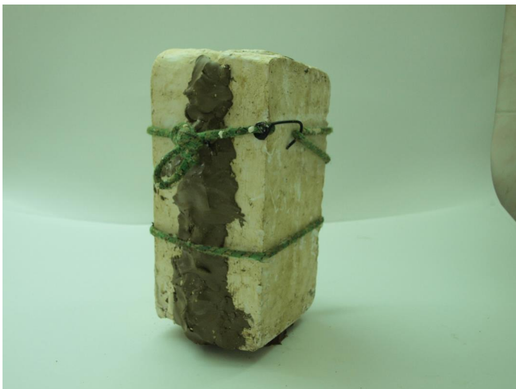
Obr. 38 Utěsnění mezer hlínou
