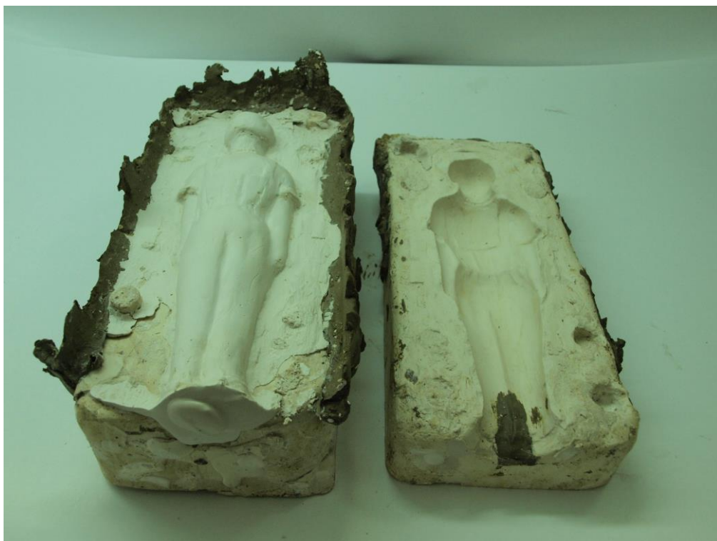
Obr. 39 Rozložená forma s odlitkem
