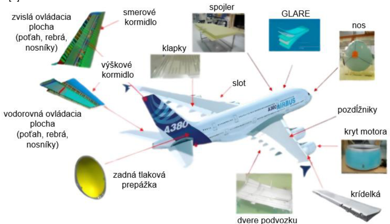
Obrázok 2 Lepené spoje na lietadle Airbus A380 (upravené) [17]
