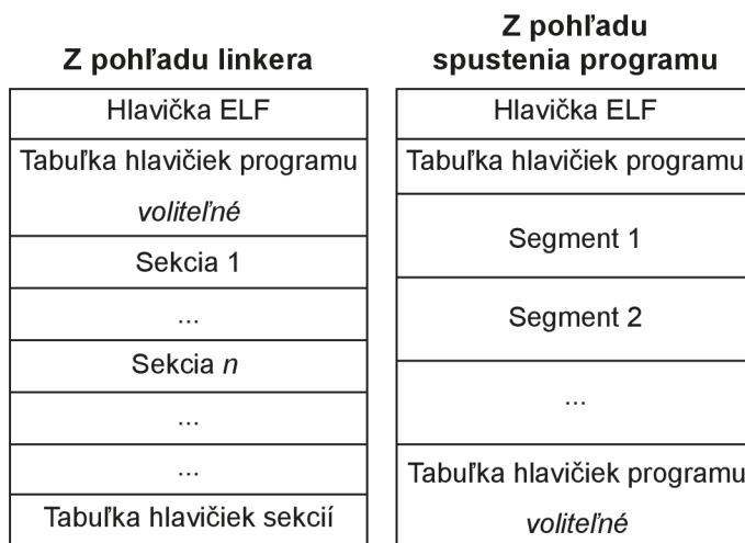
Obr. 3.1: Komplementárne pohľady na súbor ELF – Hoci obrázok ukazuje tabuľku hlavičiek programu hneď za hlavičkou ELF a tabuľku hlavičiek sekcií za sekciami, v skutočných súboroch sa to môže líšiť. Okrem toho, sekcie a segmenty nemajú definované poradie. Pevnú pozíciu v súbore má len hlavička ELF. (Prevzaté a preložené z [45])
