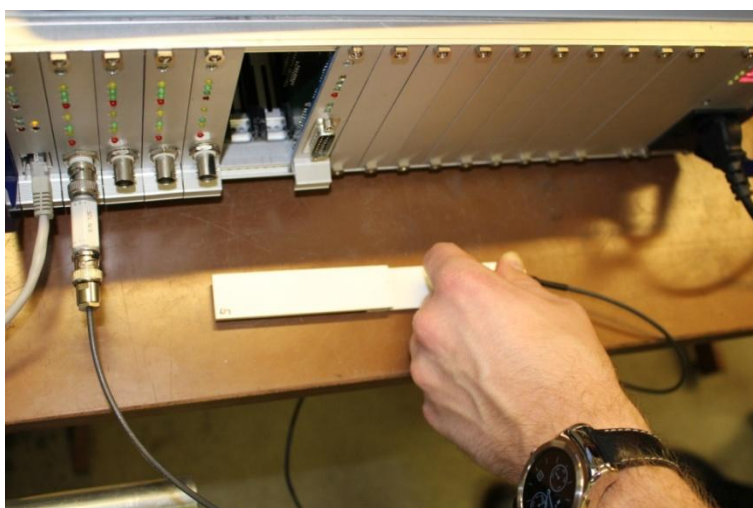
Obr. 54 Umístění snímače AE na PVC vzorek [autor]
