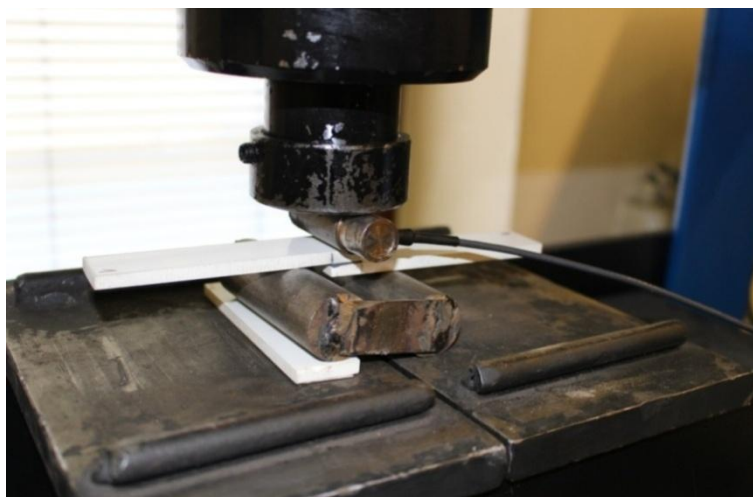
Obr. 53 Vzorek z PVC, snímač AE umístěný na válečku [autor]
