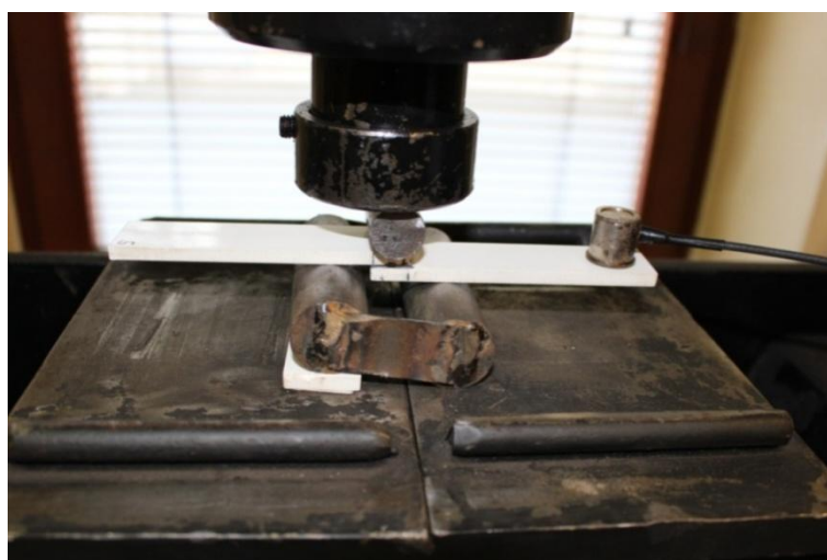
Obr. 55 Vzorek z PVC, snímač AE umístěný na materiálu [autor]
