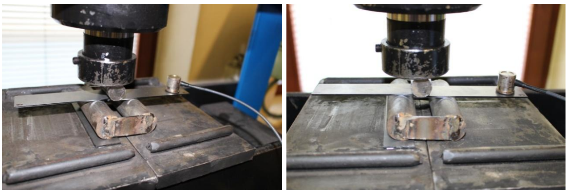
Obr. 52 Vzorky z oceli před měřením, snímač AE umístěný na materiálu [autor]
