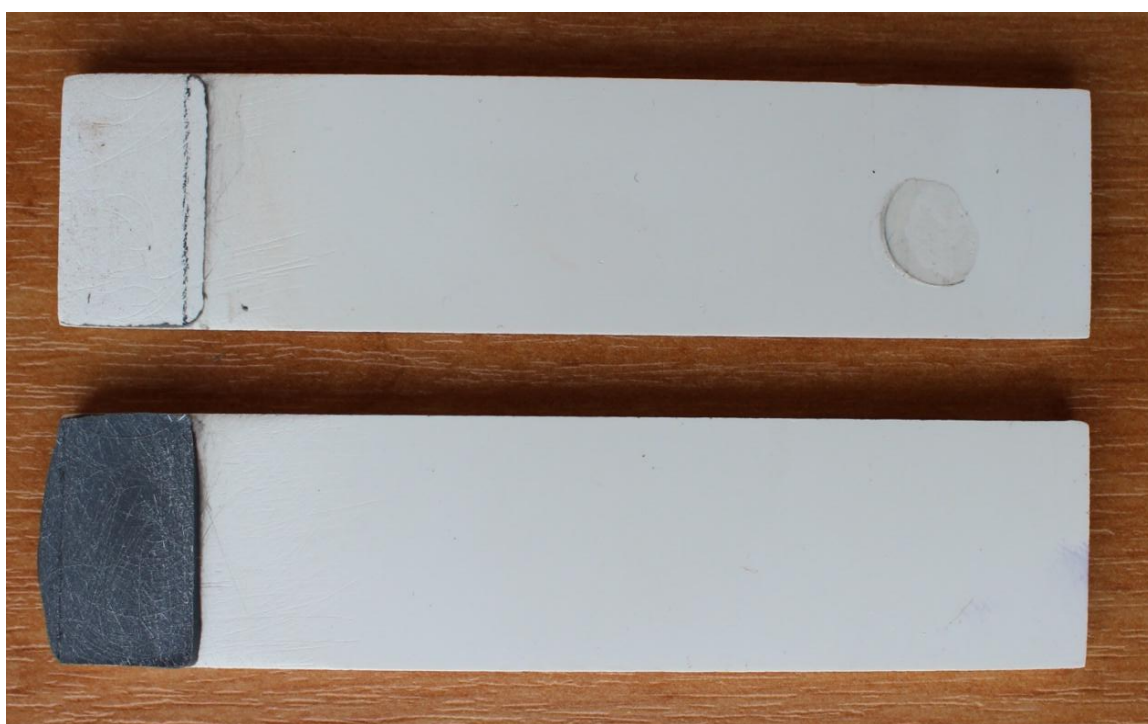
Obr. 61a Poškozený PVC vzorek 2 [autor]
