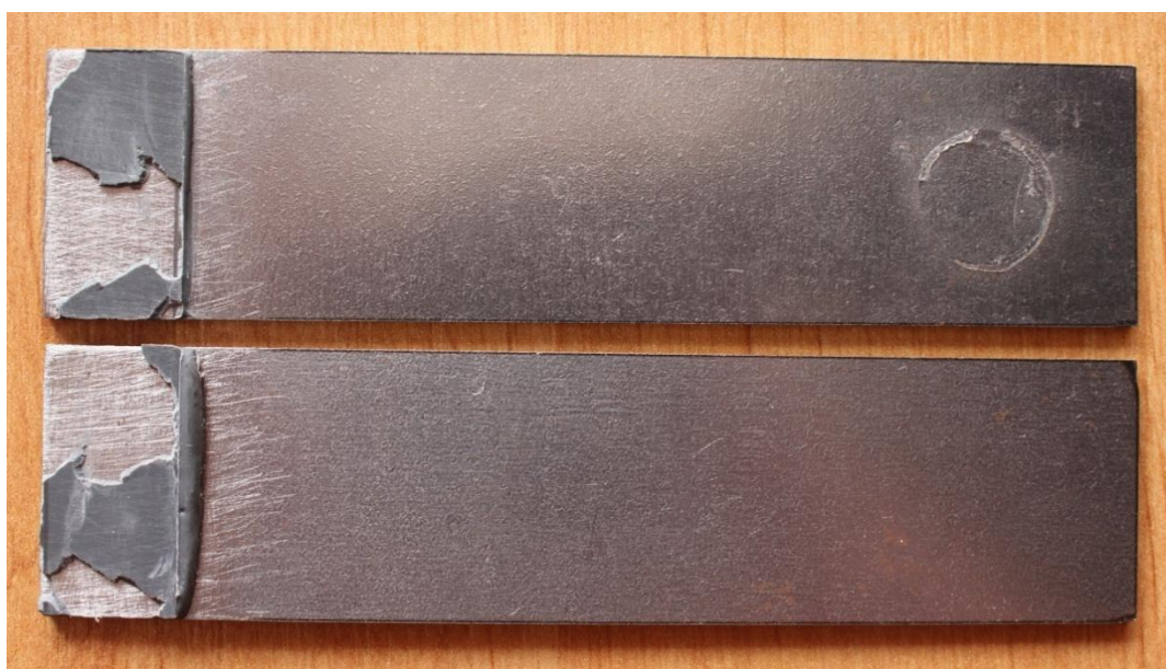
Obr. 56a Poškozený ocelový vzorek 1 [autor]
