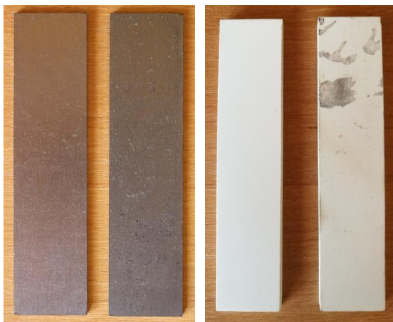
Obr. 47 Odmaštění vzorků (vlevo čistý/vpravo znečištěný povrch) [autor]
