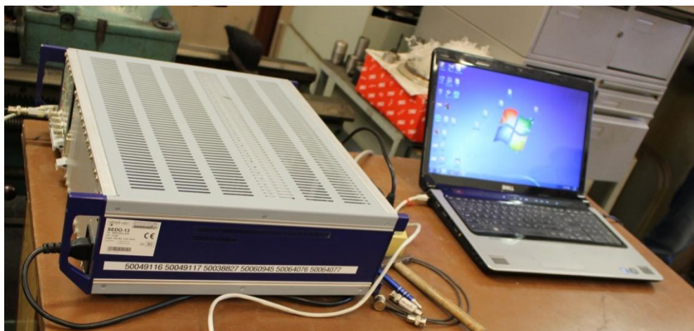
Obr. 39 Hardware diagnostického systému DAKEL – XEDO [autor]
