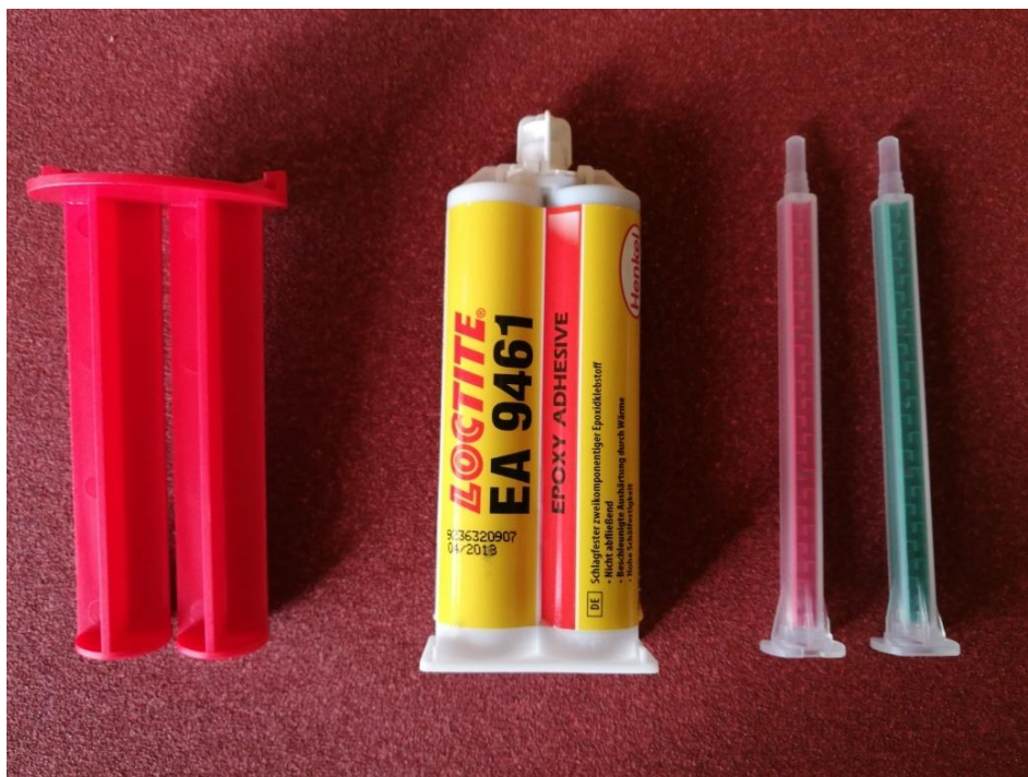
Obr. 46 Lepidlo Loctite Hysol 9461, kartušový adaptér a mixér [autor]
