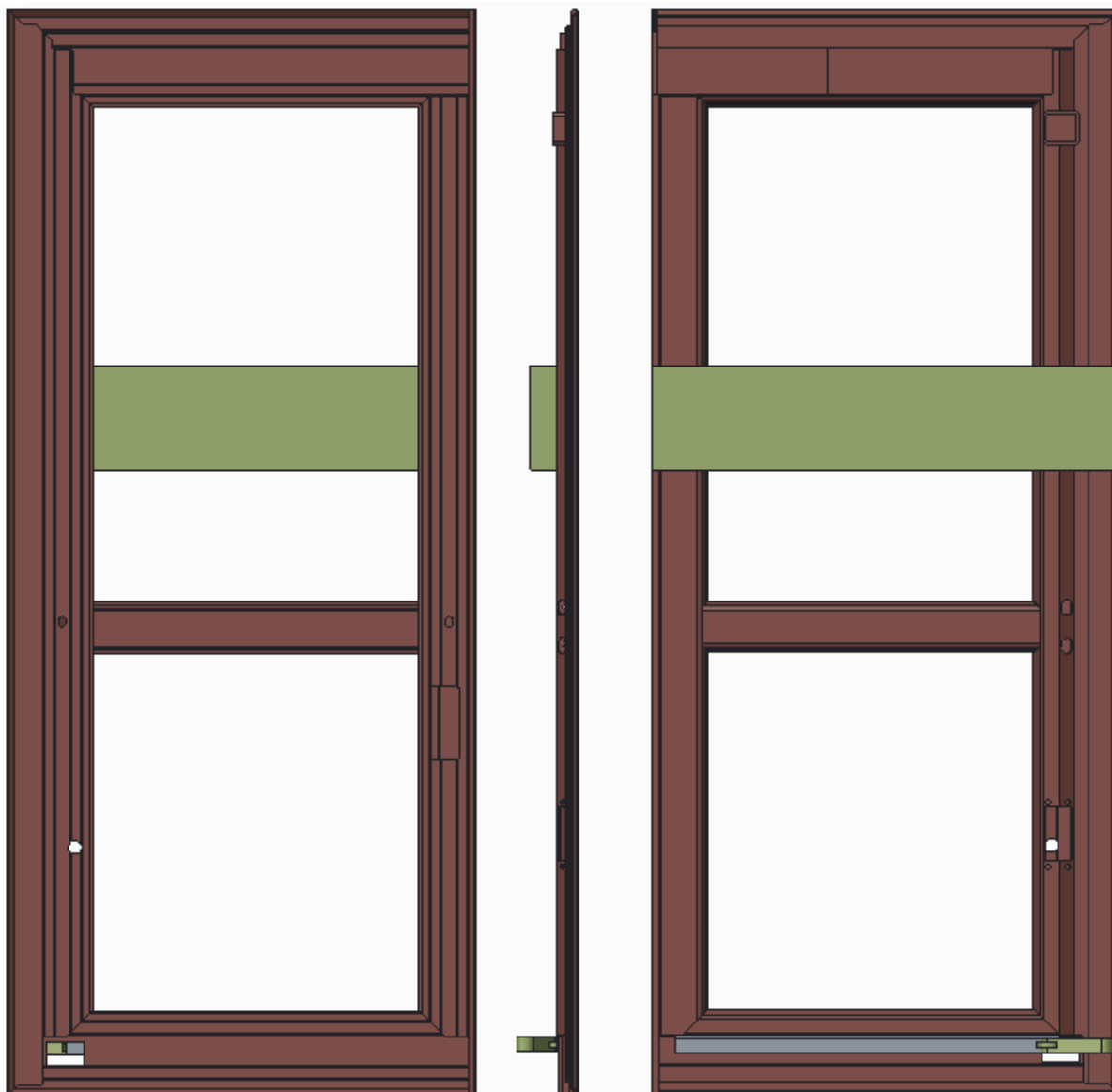
Obrázek 6.2: Finální model geometrie pro analýzu MKP
