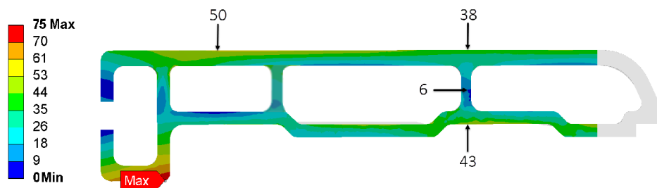
Obrázek 7.15: Rozložení redukovaného napětí podle podmínky HMM v detailu č.1 varianty Var_V2 typu T1, legenda v [MPa]
