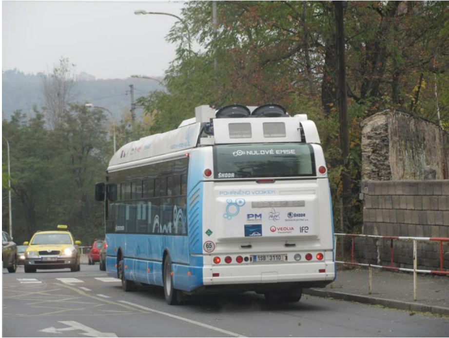
Obr. 6 - První český autobus Iveco, který je poháněný palivovými články. Autor: Tomáš Ertl
