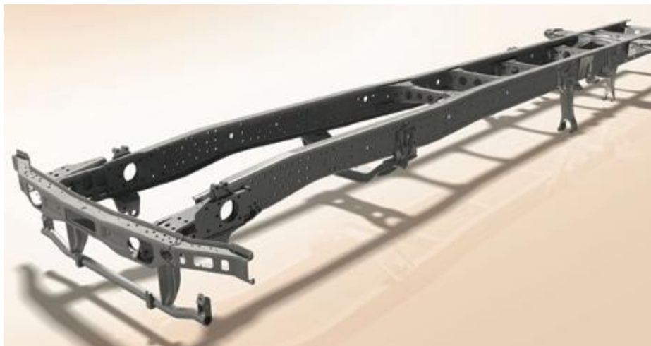
Obrázek 4 - Žebřinový rám nákladního automobilu [6]
