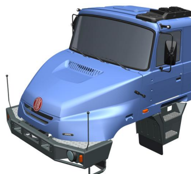
Obrázek 14 – Příklad kapotové kabiny Tatra [11]
