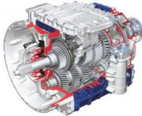
Obrázek 11 - Převodoka I-Shift společnosti Volvo [5]
