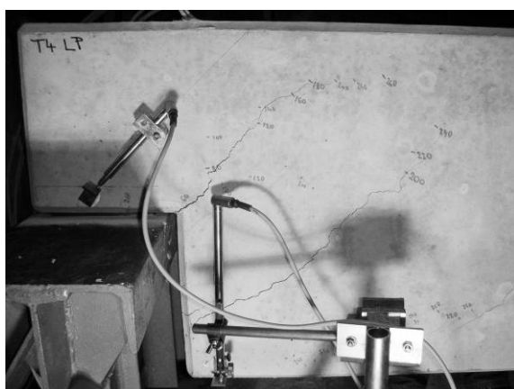
Obr. 6.20 Zhlaví E při dosažení mez. zatížení, max. šířka trhliny 1,50 mm
