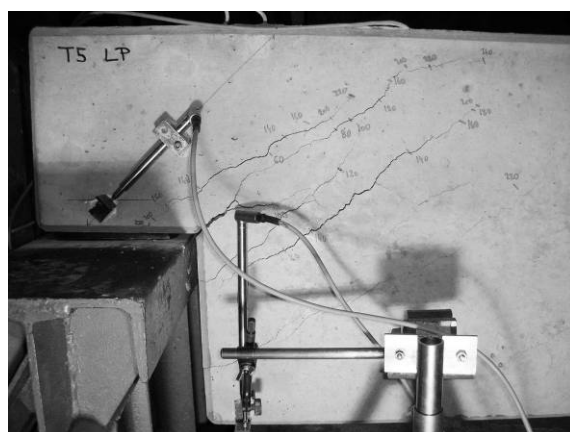
Obr. 6.21 Zhlaví A2 při dosažení mez. zatížení, max. šířka trhliny 4,00 mm
