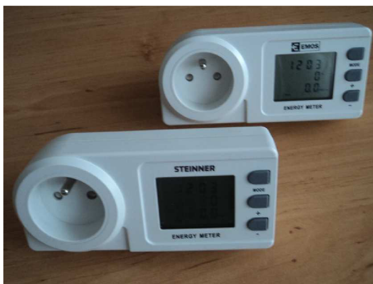
Obr. 3.1. Měřiče spotřeby elektrické energie Steinner ENM 100 a Emos FHT 9999
