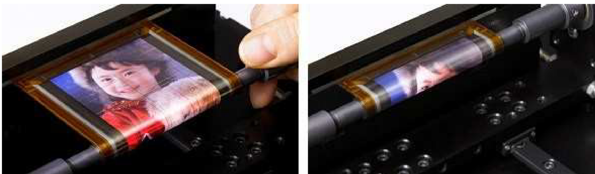
Obr. 2.8. Flexibilní organická světlo emitující dioda (FOLED) , zdroj [8]
