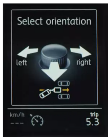
Obrázek 3.5: Asistent couvání VW - Určení směru
