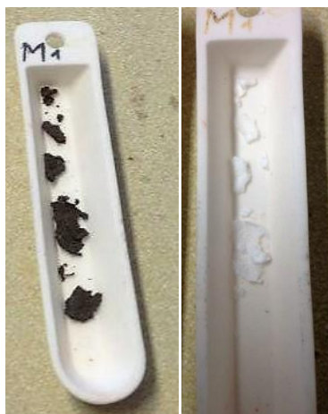
Obr. 43: Vzorek přesličky rolní po rozkladu v mikrovlnném reaktoru při působení kyseliny chlorovodíkové a po následném spálení.
