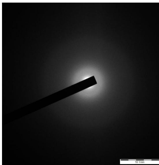
Obr. 54: Debye Shererův diagram potvrzující amorfní strukturu nanočástic oxidu křemičitého získaného z přesličky rolní.
