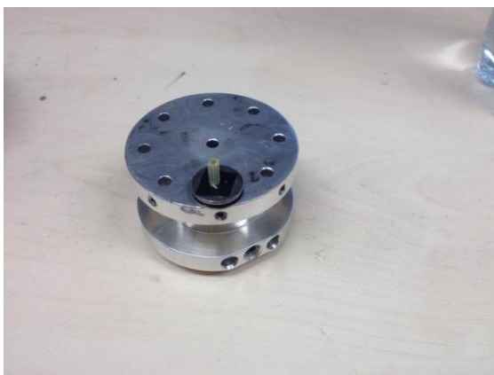
Obr. 14: Ukázka upevnění vzorků na terčíky pomocí uhlíkové pásky.
