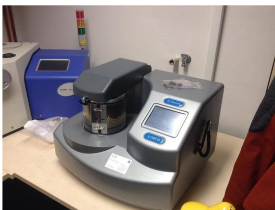
Obr. 15: Napaření vzorků tenkou vrstvou zlata nebo platiny – napašovačka QUORUM Q150 R ES.
