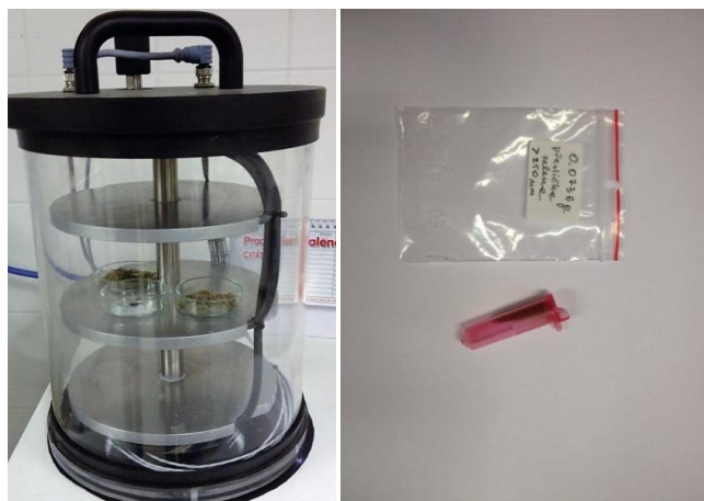
Obr. 10: Lyofilizátor s vloženými vzorky přesličky rolní. Vzorky pro TGA analýzu.
