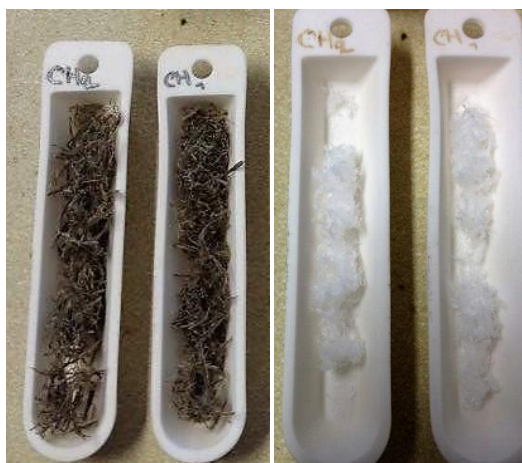
Obr. 44: Vzorek přesličky rolní po chemickém přečištění kyselinou chlorovodíkovou a po následném spálení.
