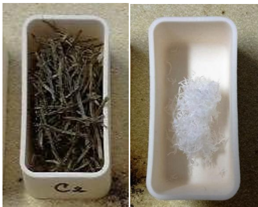
Obr. 45: Vzorek přesličky rolní po chemickém přečištění kyselinou citrónovou a po následném spálení.
