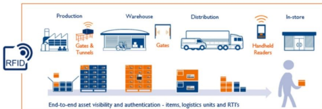
Obr. 2.5 Tok výrobku s využití RFID technologie
