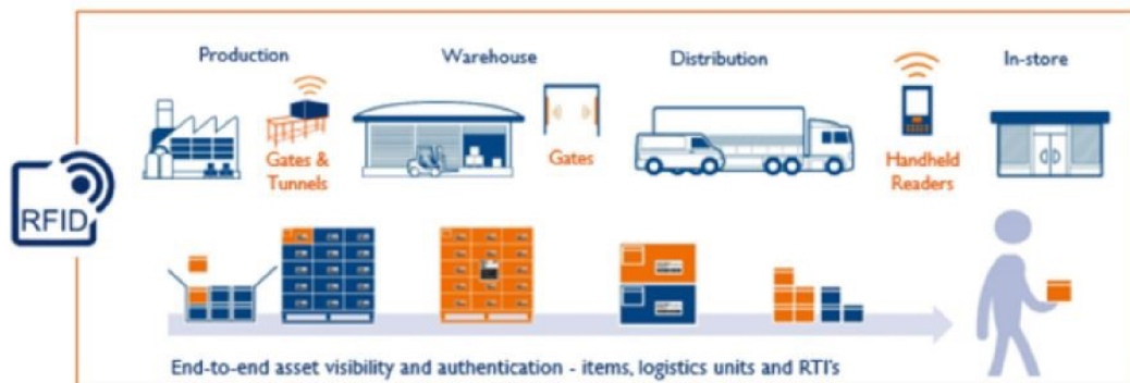
Obr. 2.5 Tok výrobku s využití RFID technologie
