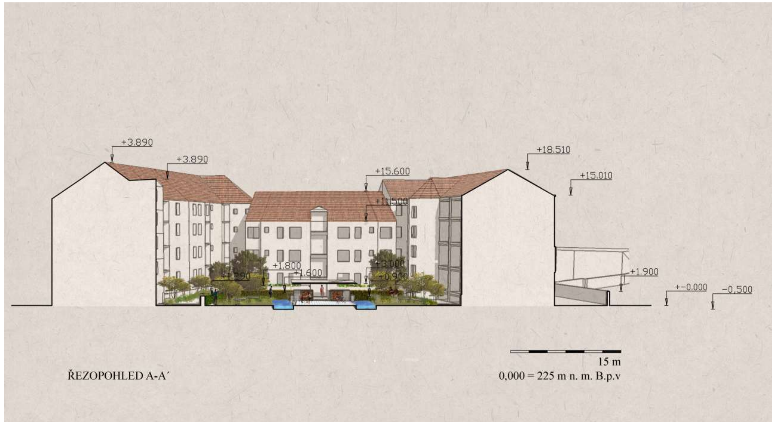
Obr. 19 ŘEZPOHLED A - A'
