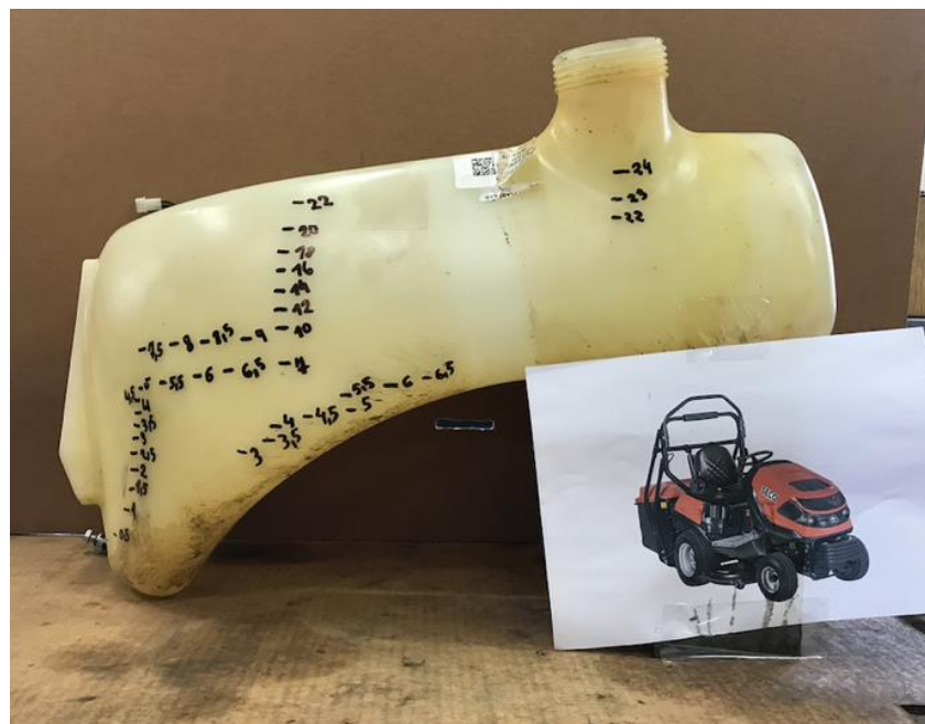
Obrázek 12 Měření objemu palivové nádrže
