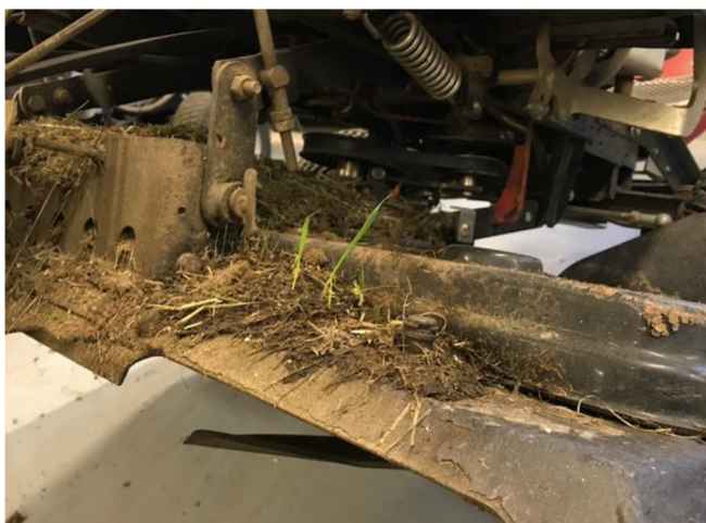
Obrázek 7 Špatně udržované žací ústrojí na stroji Starjet P5 110
