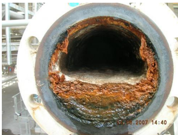
Obrázek 2.19 Biologicky znečištěná trubka [33]
