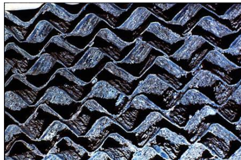
Obrázek 2.18 Usazeniny ve výplni věže [31]
