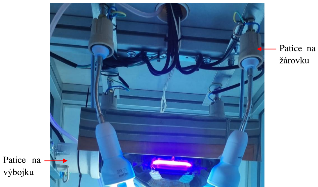
Obrázek 15: Upevnění rtuťové výbojky UV black light 400 W a žárovek Repti Planet UVB 26 W pomocí patic.
