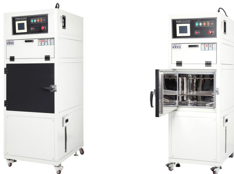
Obrázek 7: Xenonový obloukový weatherometer [42].
