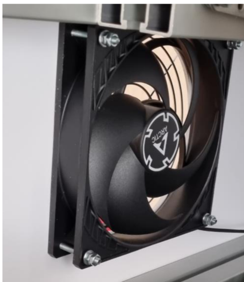
Obrázek 13: Ventilátory zajišťující nepřehřívání prostoru v přístroji na simulaci degradace materiálů (PSDM).
