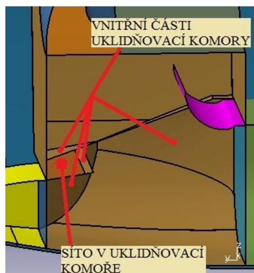
Obr. 8.16: Dolní část nové uklidňovací komory
