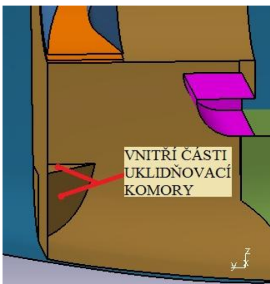
Obr. 8.15: Dolní část původní uklidňovací komory
