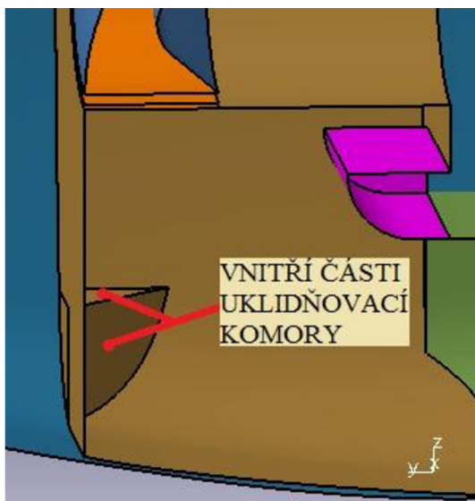
Obr. 8.15: Dolní část původní uklidňovací komory
