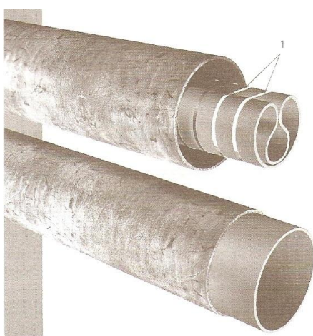
Obr. č. 27 - Sanace potrubí metodou Subline, zdeformovaná vložka a vyrovnaná vložka
