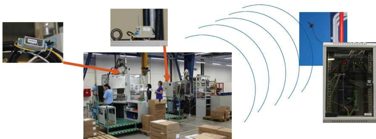
obr.4.: Reálné nasazení bezdrátového sběru dat WAGO – EnOcean.[9]
