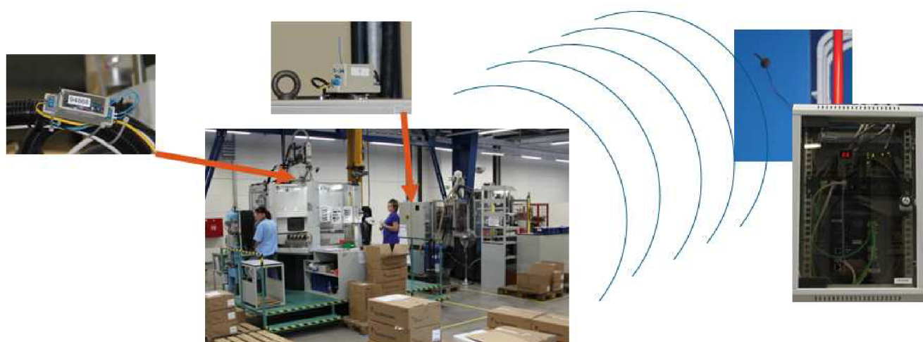
obr.4.: Reálné nasazení bezdrátového sběru dat WAGO – EnOcean.[9]
