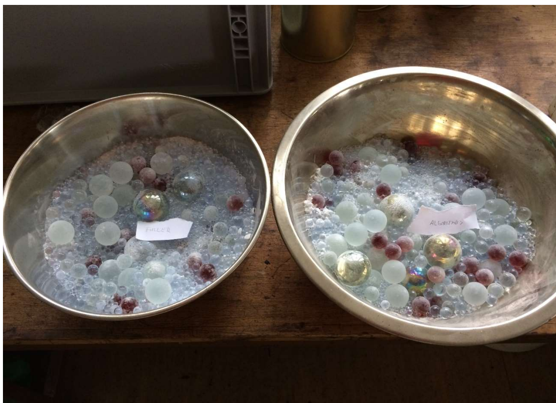
Obrázek 16: Navážené směsi pro praktické porovnání (vlevo směs dle Fullerovy paraboly, vpravo směs dle algoritmu náhodné volby zrn)
