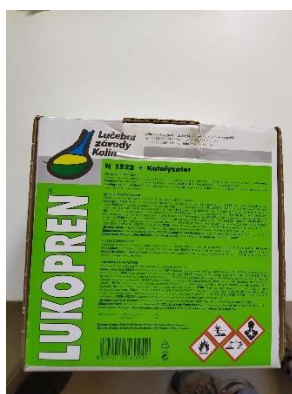
Obr. 89 Dvousložkový silikonový kaučuk, Lukopren N 1522
