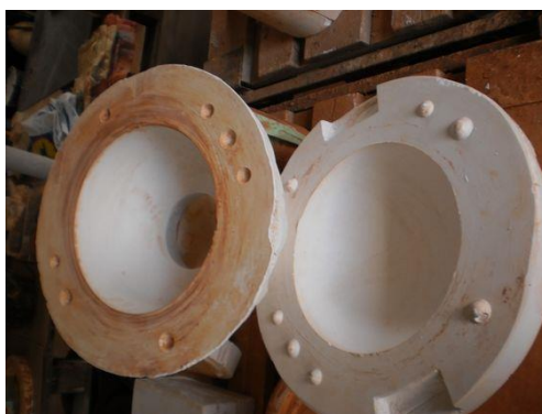
Obr. 15 Ukázka dvoudílné sádrové formy
