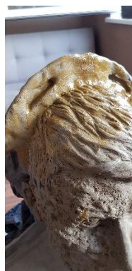
Obr. 87 Separování modelu šelakem I.
