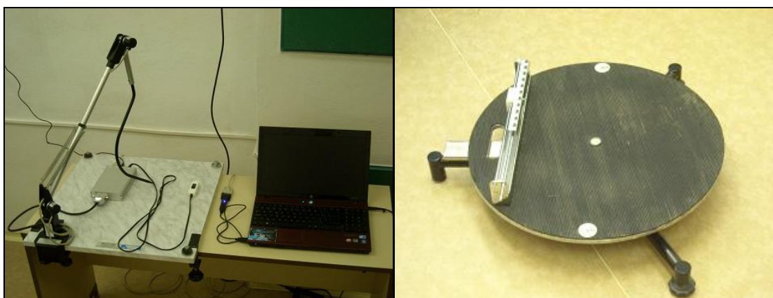
Obrázek 33. Diagnostický systém DTP-2 – vlevo celý systém, vpravo otočná plošina (fotoarchiv Karolíny Lysákové, 2010).
