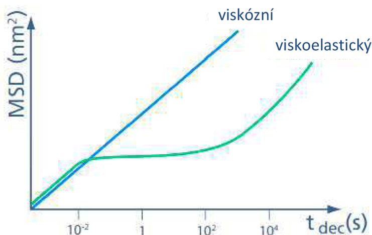
Obrázek 9: Závislost MSD na čase pro viskózní a viskoelastický materiál [27]
