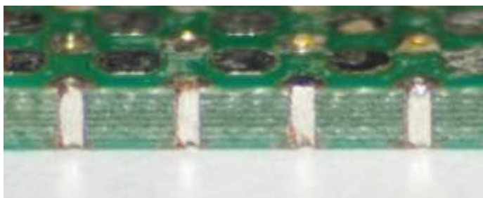
Obr. 11: Detailní pohled na přípojovací plošky-vyplnění otvorů v pájecí vlně
