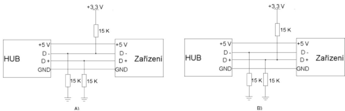
Obr. 3: Hardwarové zapojení pro specifikaci: A) Low speed B) High speed a Full speed (upraveno z [8])
