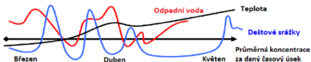
Obrázek 9: Integrativní pasivní vzorkovače - průměr koncentrace polutantu (Rodsand, 2016).
