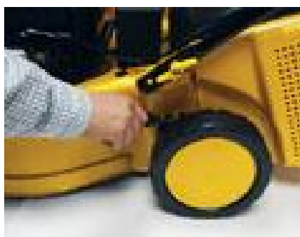
Obrázek 25 – Nastavení výšky kol
