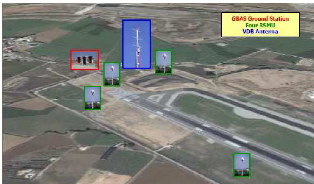
Obr. 34 Rozmístění pozemních komponent systém GBAS na letišti Malaga (Španělsko)
