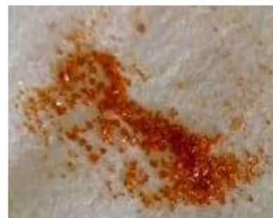
Obr. 5 – Žlutooranžové krystaly sloučeniny [Pd(qao)(qaoH)](NO_3) ; Převzato od Dr. Theocharise C. Stamatatose
