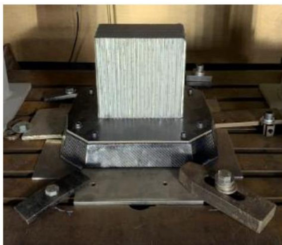
Obr. 17 Absorbér monopostu ED2 před a po pádové zkoušce, [30]
