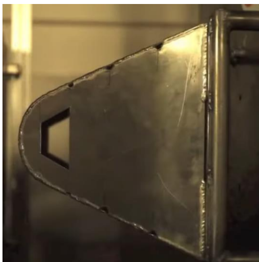
Obr. 13 Hliníkový absorbér nárazu týmu ULM racing [27]
