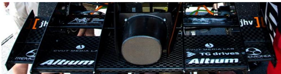
Obr. 15 Kompozitní sendvičový absorbér, [28]
