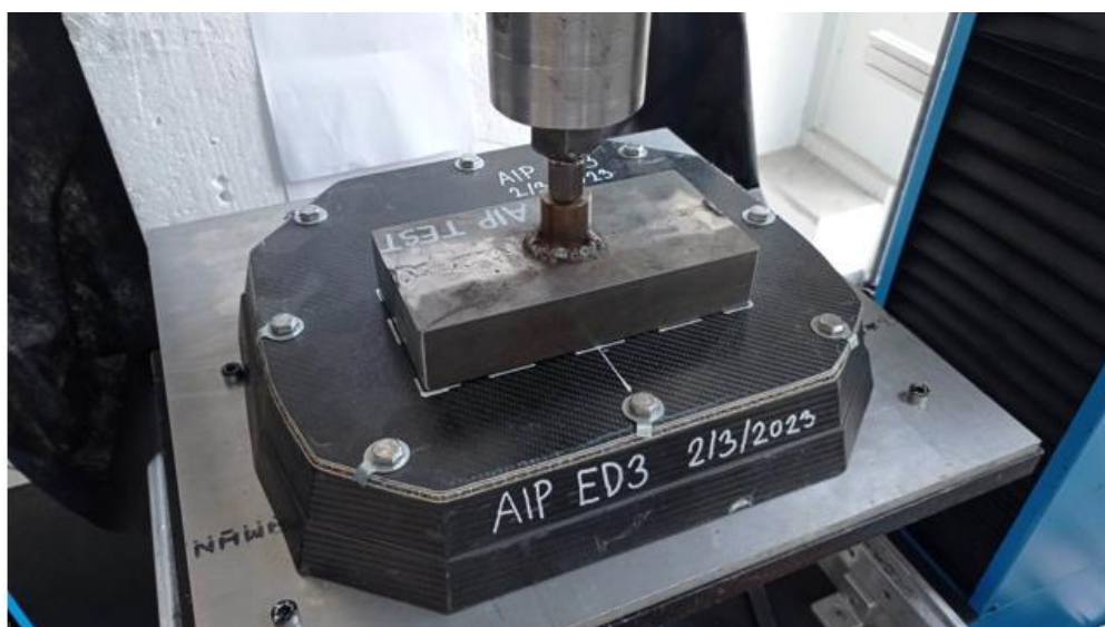
Obr. 32 Test nepropustné přepážky, [42]
