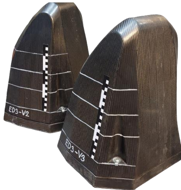
Obr. 36 Absorbéry připraveny pro pádové zkoušky
