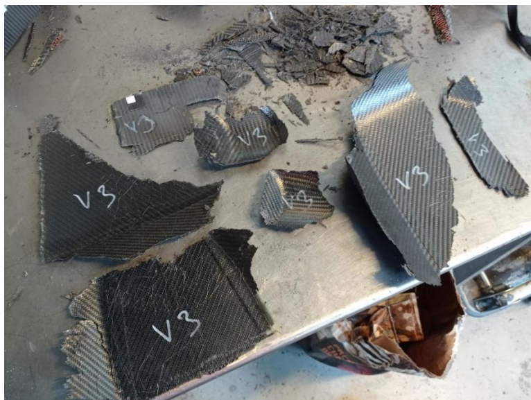
Obr. 39 Úlomky z přední části absorberu (první segment)
