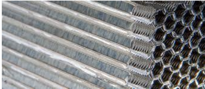
Obr. 22 Předdeformovaný voštinový pohlcovač [26]
