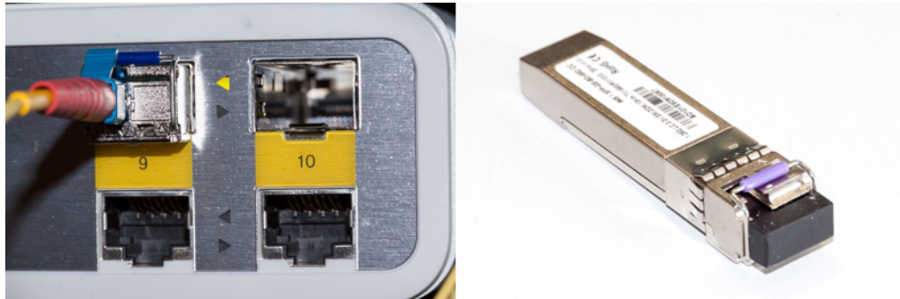
Obr. 4.3: SFP slot v ľavo, WDM MiniGBIC modul v pravo
