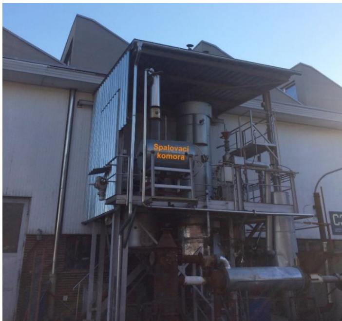
Obr. 29: Spalovací komora jako součást experimentálního zplyňovacího zařízení
