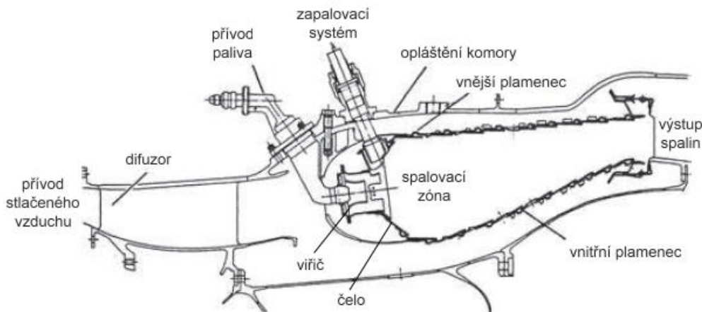
Obr. 13: Podélný řez souproudou spalovací komorou [7] (upraveno)
