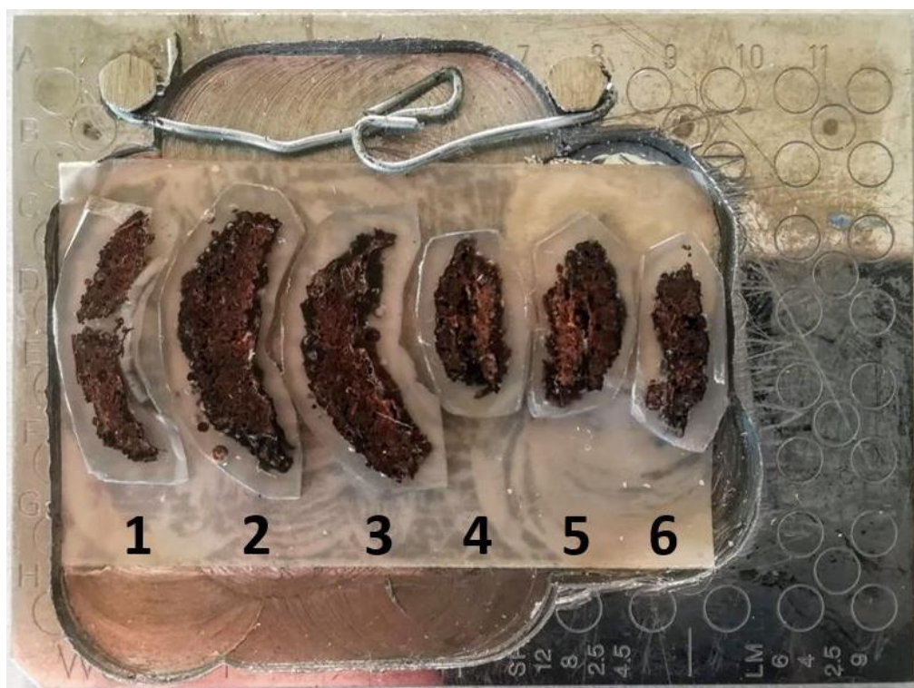
Obrázek 16: MALDI destička s výbrusy pažní kostí; 1: demineralizovaná, čistá kost; 2: demineralizace, překrytí 3 M HCl; 3: demineralizace, překrytí trypsinem; 4: kost bez demineralizace, překrytí 3 M HCl; 5: bez d., překrytí trypsinem; 6: bez d., čistá kost
