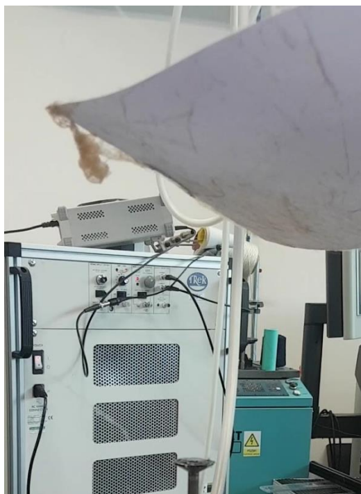
Obrázek 4.4: Reálný obrázek experimentu zvláknování metodou střídavého napětí s viditelnou elektrodou a připravenými vlákny
