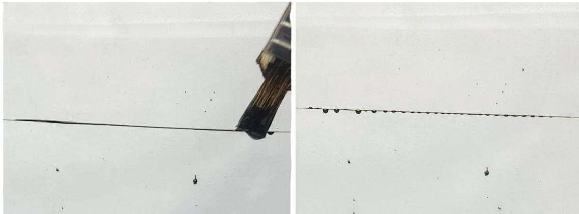
Obrázek 4.2: Průběh měření relaxačního času Rayleighovy-Plateauovy nestability. Nanesení roztoku (vlevo) rozpad na kapky (vpravo).
