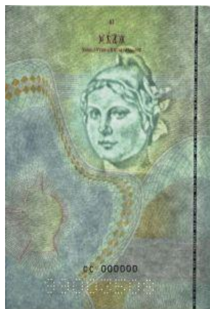
Obrázek 3: Vodoznak CZE-AO-02002 Zdroj: Doklad: CZE-AO-02002. PRADO [online]. Brusel: Generální sekretariát Rady Evropské unie, 2023 [cit. 2023-03-02]. Dostupné z: https://www.consilium.europa.eu/prado/cs/CZE-AO-02002/index.html#sec-feat-2-1
