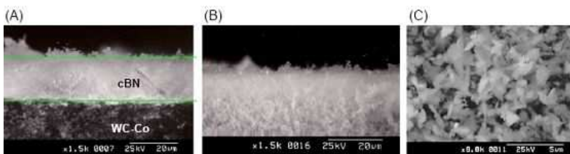
Obr. 4.3 (A) Vrstva KNB o tloušťce 13 μm, (B) povlak poblíž špičky nástroje, (C) póry v povlaku KNB 20
