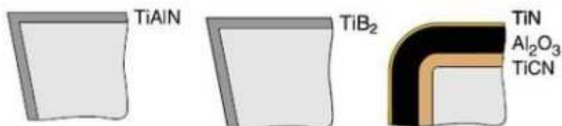
Obr. 5.10 Řazení vrstev povlaku u materiálů KC5010, KC5410 a KC8050 24
