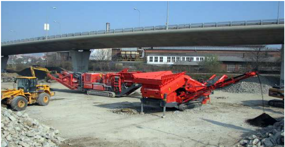
Odrazový drtič FINLAY I-1310 RS v pozadí, v popředí FINLAY 883 RECLAIMER (ŽSD, a.s., interní dokumentace)
