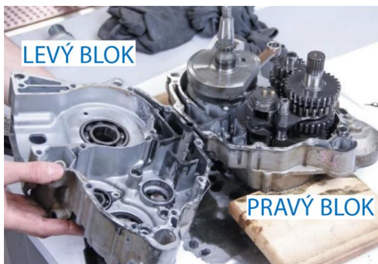
Obr. 3.8 – Rozpůlený blok motoru, podle [10]
