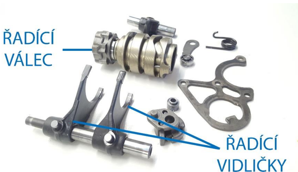
Obr. 3.4 – Řadící válec, řadící vidličky, podle [8]
