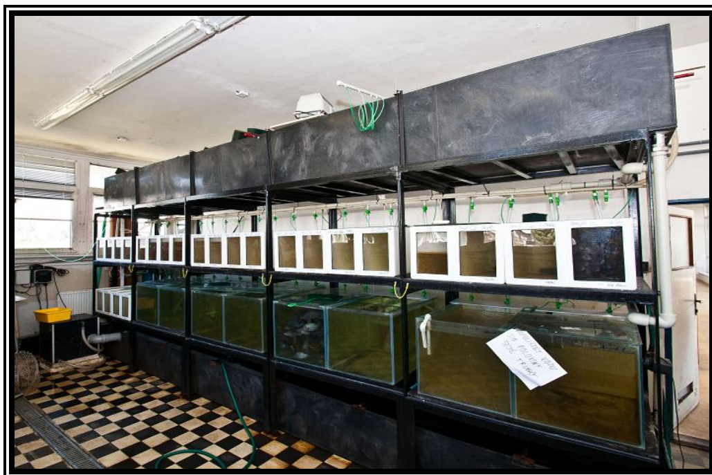
Obr. č.6. Experimentální recirkulační systém (odchovné nádrže, mechanický filtr, retenční nádrž, biologický filtr)
