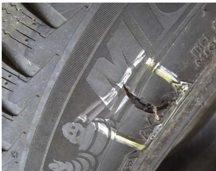
Obr. 20 Prasklá bočnice pneumatiky
