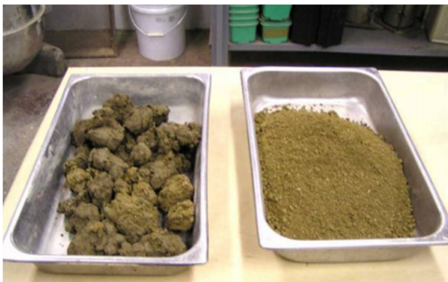
obr. 16: Plastická zemina bez vápna (nalevo) a upravená zemina s vápnem (napravo)
