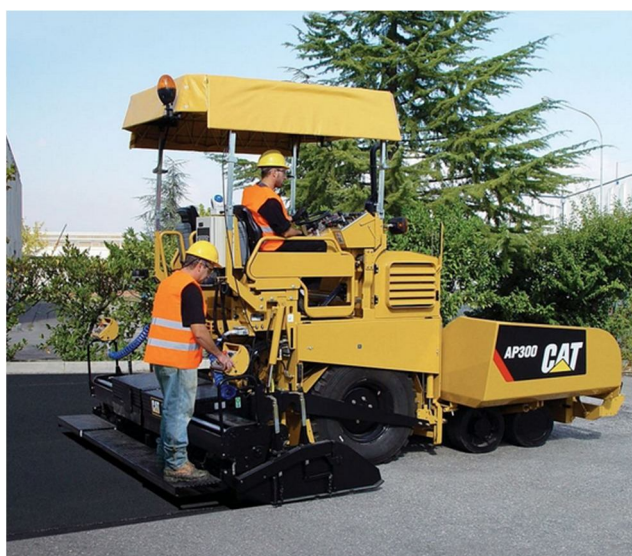
Obr. 32: Kolový finišer Caterpillar AP 300
