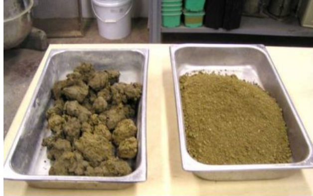
obr. 3.2.8: Neupravená zemina (vlevo) a upravená zemina vápnem (vpravo)
