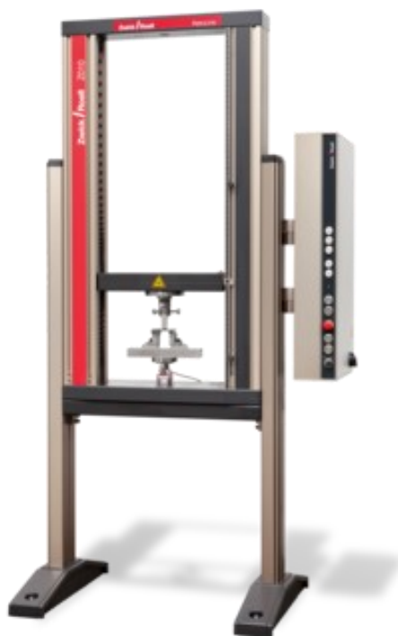
Obr. 3.3: Snímek testovacího zařízení Zwick Z010/TH2A [26]
