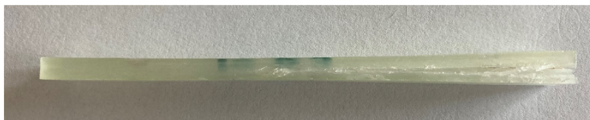
Obr. 4.4: Snímek deformovaného vzorku obsahujícího vlákna C
