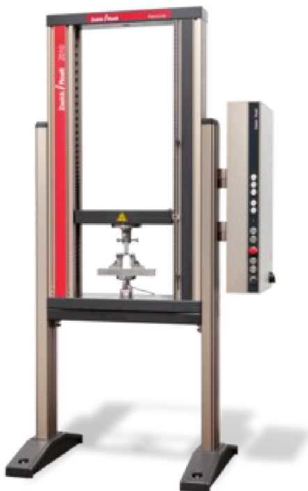
Obr. 3.3: Snímek testovacího zařízení Zwick Z010/TH2A [26]
