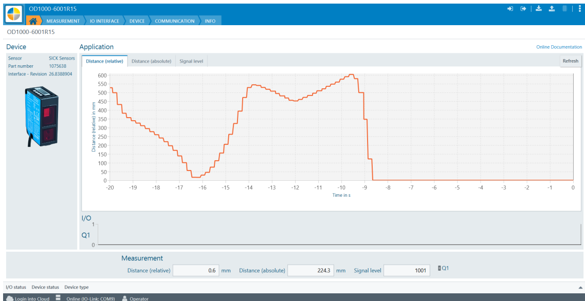
Obrázek 1.5: Program pro ovládání laserového senzoru
